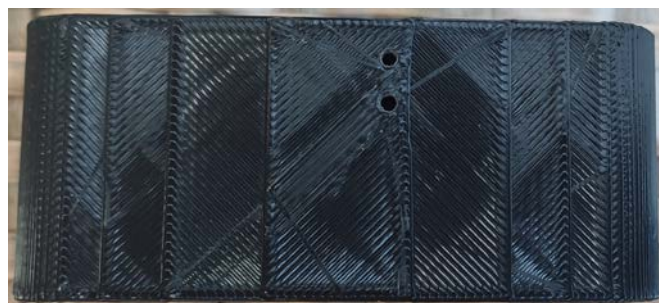
Slika 5. Gornja površina poklopca kućišta – orijentacija broj 6
