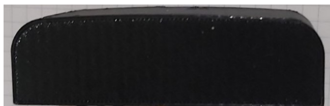
Slika 9. Gornja površina poklopca je sferna i nije prisutan efekat stepenica - orijentacija broj 4
