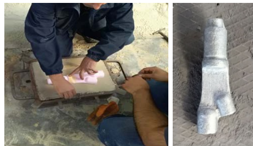
Slika 10. Postupak izrade kalupa za livenje u pesku.
