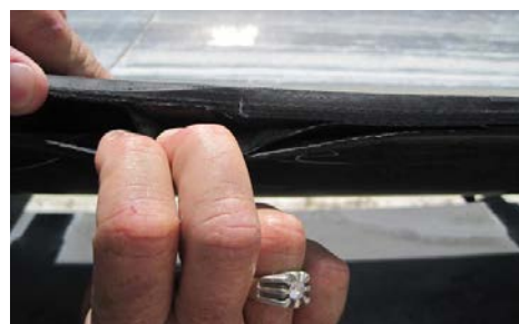
Slika 2. Raslojavanje transportne trake na ivici.
