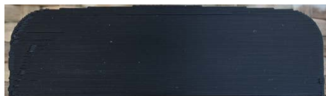
Slika 6. Efekat stepenica na gornjoj površini poklopca kućišta - orijentacija broj 6
