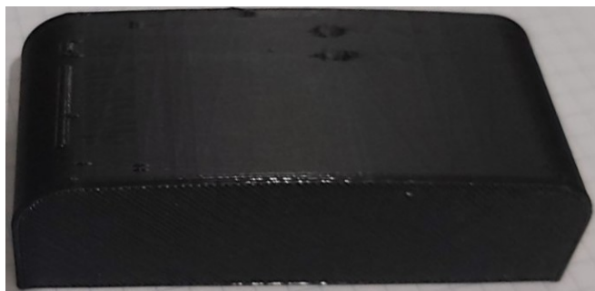
Slika 8. Gornja površina poklopca kućišta – orijentacija broj 4
