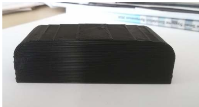
Slika 4. Finalni proizvod poklopca kućišta – orijentacija broj 6
